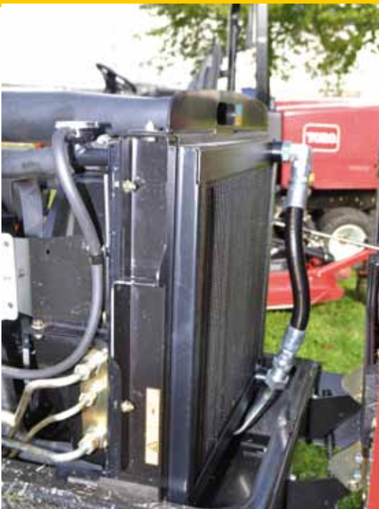
Eén koelblok. De omkeerbare, zelfdenkende fan houdt tegelijkertijd de olie- en de waterradiator schoon.
