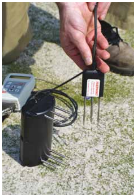
Anders dan de HH2 registreert de ingegraven Turfguard-sensor gegevens over de situatie in de bodem op twee niveaus.
