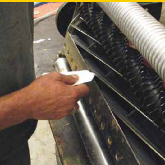
Bij de 'non-contact'-methode past het bekende velletje papier er tussen.
